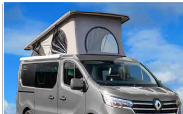
Aufstelldach mit Fenster
